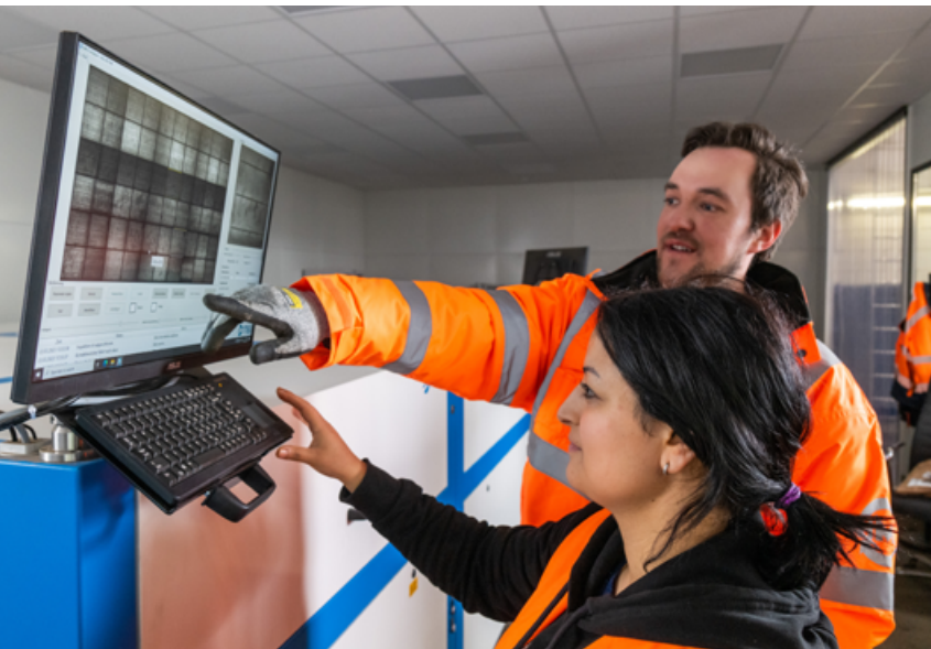
Abb 5 — Bewertung von Zellschäden mittels Elektrolumineszenz-Verfahren •
