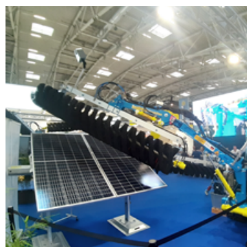
Abb 3 — Großflächen-Reinigungsmaschinen für Freiflächen-PV in Wüstengebieten •
