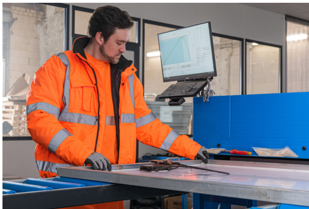
Abb 7 — Leistungs- und Isolationsmessung in der Prüfstraße bei 2nd Life Solar •
