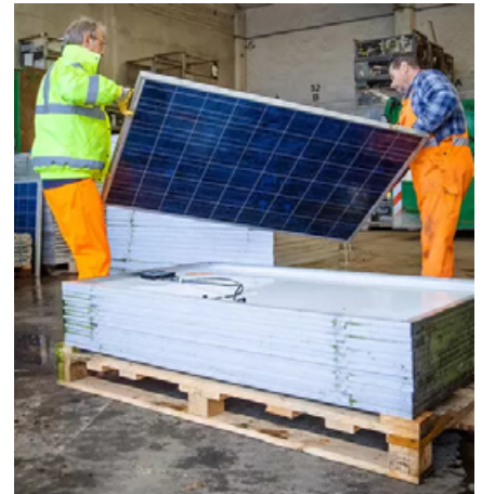
Abb 3 — Vorsortierung gebrauchter Solarmodule nach visuellen Defekten •
