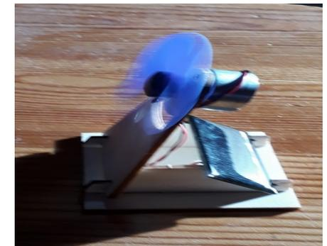
4. Ein **Solarboot** wird mit dem gleichen Motor und Propeller betrieben. Was ist zu beobachten, wenn die erwärmte Solarzelle mit Wasser benetzt wird? **Lösung/Anwendung:** Werden Solarzellen/Solarmodule gekühlt, steigt deren Leistung - siehe Dachanlagen, die mit Abstand zum Dach montiert sind.
