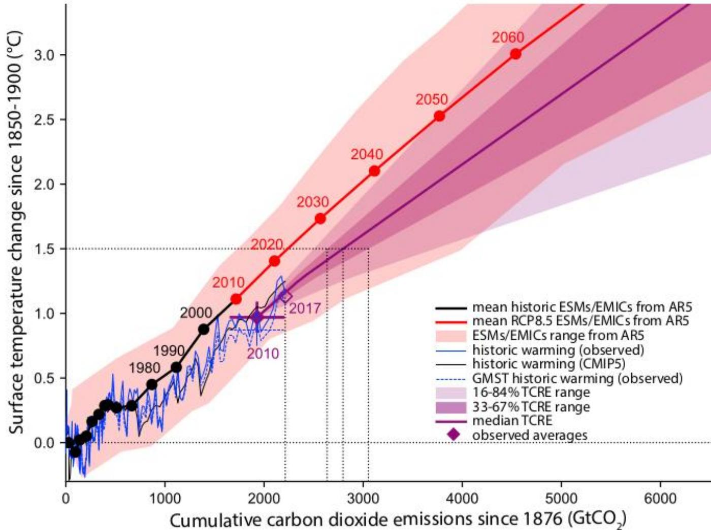
Auf der X-Achse sind die kumulativen CO<sub>2</sub>-Emissionen in Gt CO<sub>2</sub> seit 1876 abgebildet, auf der Y-Achse die Veränderung der bodennahen Lufttemperatur (°C) seit dem Zeitraum 1850 – 1900. Die schwarze Linie zeigt die von Erdsystemmodellen berechnete Erwärmung auf Basis historischer Emissionen. Die rote Linie zeigt die projizierte Erwärmung auf Grundlage eines Business-as-usual-Szenarios. Beide Verläufe entstammen dem Fünften Sachstandsbericht des IPCC (AR5).
