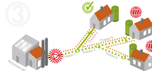
Abb. 26: 3. Zentrale Pumpe läuft, alle Pufferspeicher mit Bedarf werden geladen; dann Ruhezustand.
