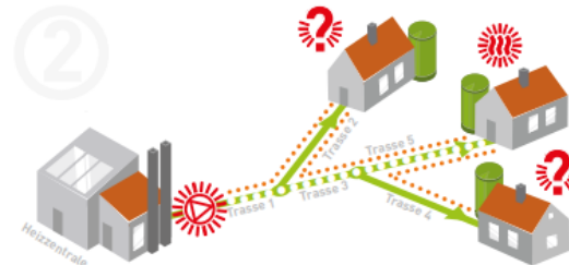
Abb. 25: 2. Zentrale Pumpe läuft, Pufferspeicher wird geladen; weitere Pufferspeicher werden auf Bedarf abgefragt.
