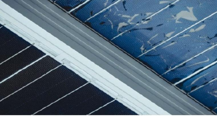
**Abb 3** — Ansicht eines Moduls vor und nach dem Lichtblitz: Durch den Blitz ist es möglich die Verbundmaterialien des Moduls zu trennen.
