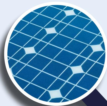
Solarmodule bestehen aus elektrisch miteinander verbundenen Solarzellen. Innerhalb der Solarzelle entsteht der elektrische Strom mit Hilfe von Halbleitern. Bei den üblichen mono- und polykristallinen Modulen kommt Silizium als Halbleiter zum Einsatz. Es gibt aber auch Solarzellen mit anderen Halbleitermaterialien.
