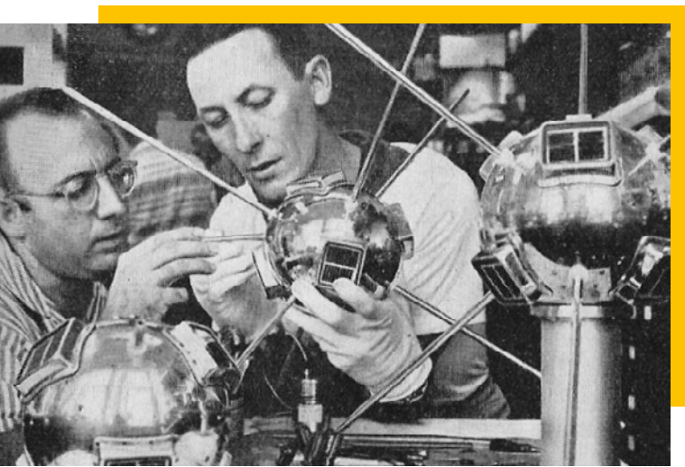
Abb 2 — Der Vanguard 1 ist der erste Satellit, der Solarzellen für die Stromversorgung verwendete. Er wog nur 1,5 kg. Foto: NASA •
