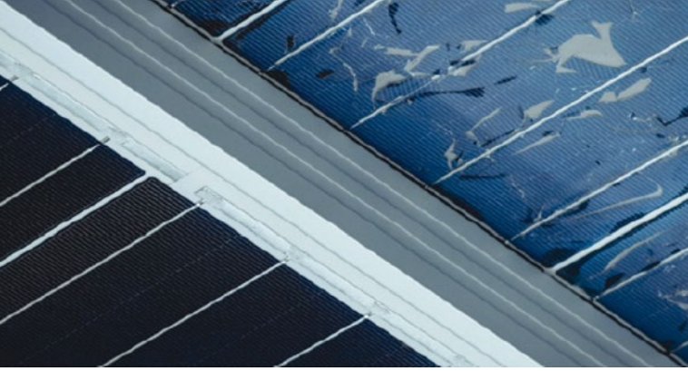
Abb 3 — Ansicht eines Moduls vor und nach dem Lichtblitz: Durch den Blitz ist es möglich die Verbundmaterialien des Moduls zu trennen. Foto: FLAXRES in: Konrad Mertens, "Photovoltaik - Lehrbuch zu Grundlagen, Technologie und Praxis", Hanser Verlag, 2022 •
