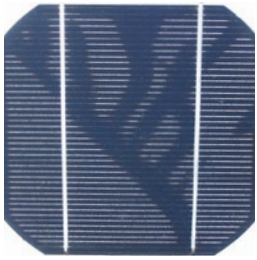
Abb 6 — "Schnecken Spuren" weisen auf Zellbrüche hin •
