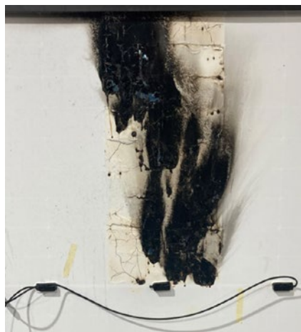
Abb 8 — Das Bild zeigt ein Modul, bei dem die mittlere Bypassdiode nicht korrekt verlötet war. Das Modul war Teilverschattung ausgesetzt. •
