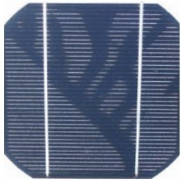
Abb 6 — "Schneckenspuren" weisen auf Zellbrüche hin.
