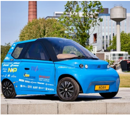
Abb 2 — Prototyp "Noah" besteht zu 90% aus recycelbaren und nachwachsenden Materialien wie Flachs, Harz, Bioplastik aus Zucker. © TU Eindhoven •
