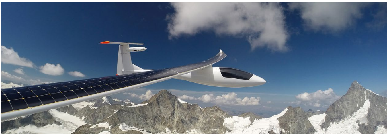
Abb 15 — Die zweisitzige "Sunseeker Duo" der Firma "Solar Flight". Der Propellerantrieb ist vor dem Seitenleitwerk zu erkennen. © Photos by Eric and Irena Raymond •
