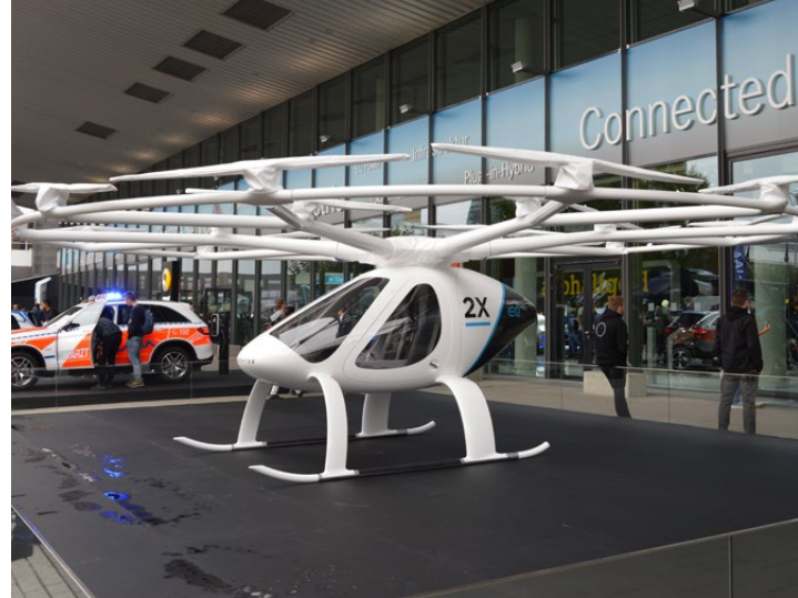
Abb 1 — Der Volocopter 2X ist ein elektrisch angetriebenes, autonom fliegendes Luftfahrzeug für 2 Personen. Hier vorgestellt bei der IAA 2017. Foto: CC BY-SA 4.0 by Spielvogel •
