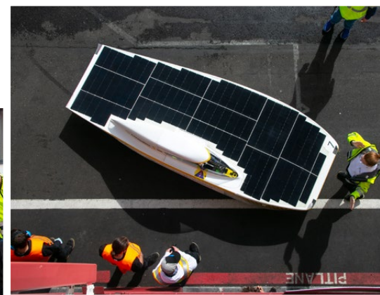
Abb 3 — Der Photon ist mit 4m 2 Solarzellen und einer 6 kWh Batterie ausgestattet. Mit seinen 190 kg Gesamtgewicht kommt er so auf maximal 120 km/h.
