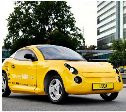
Abb 3 — "Luca" wurde weitgehend aus Müll produziert: recycelte PET-Flaschen, ABS-Kunststoff, Fenster, und recyceltem Plastikmüll im Innenraum © TU Eindhoven •
