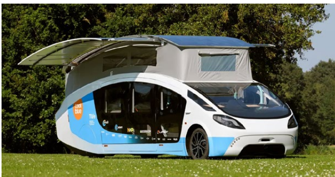
Abb 8 — 17 m 2 Solarpaneele laden die Stella Vita in 3 Tagen auf - für 600 km Reichweite. © 2022 Solar Team Eindhoven •
