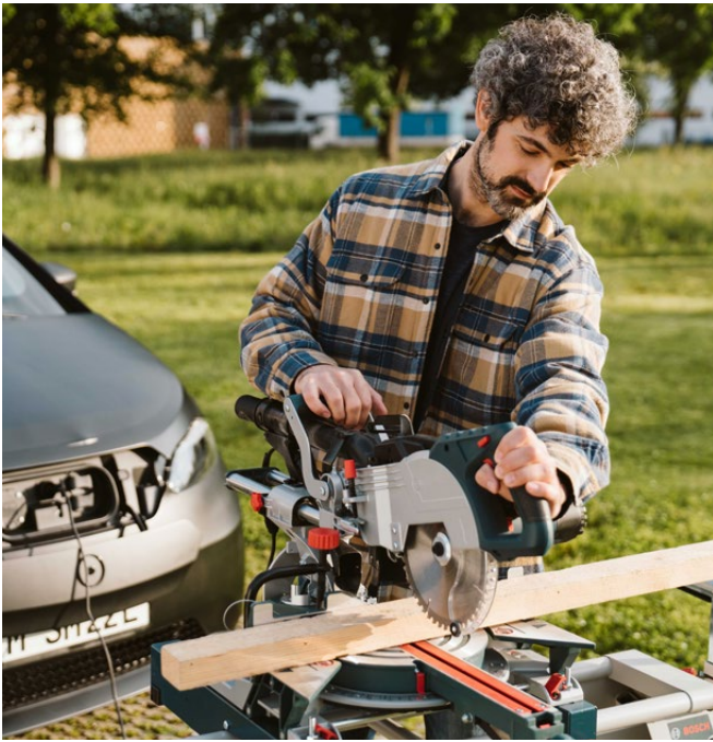
Abb 7 — Mit der Funktion "Vehicle to Device" werben mittlerweile mehrere E-Autohersteller. Elektrische Geräte können über die Autobatterie aufgeladen oder betrieben werden. © SonoMotors •
