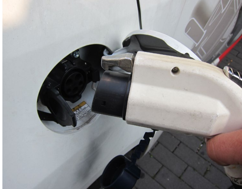
Abb 2 — Ladestecker Typ 2 für Wechselstrom (AC). Foto E. Waffenschmidt •
