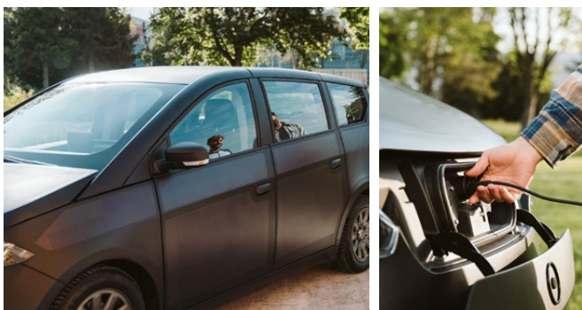
Abb 5 — Der Fünfsitzer Sion integriert Solarzellen auf Dach, Motorhaube und Seitenwänden. Bidirektionale Ladefunktion inklusive. © SonoMotors •
