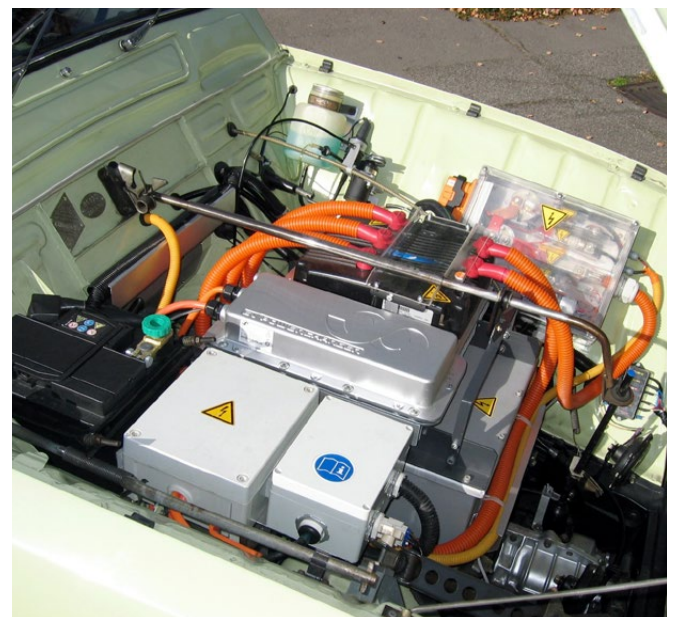
Abb 2 — Im fertigen Motorraum ist der Antriebsstrang ganz unten versteckt. Akku und Leistungselektronik liegen darüber •
