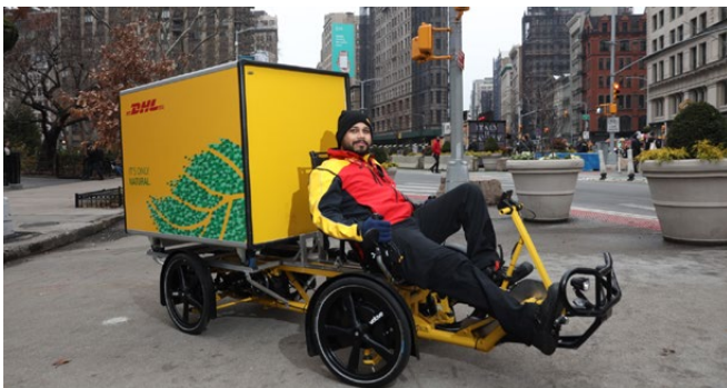
Abb 7 — Seit 2017 auf der Straße: der Cubicycle zur Postausstellung wird mit Sonnenenergie vom Boxdach unterstützt © Deutsche Post AG •
