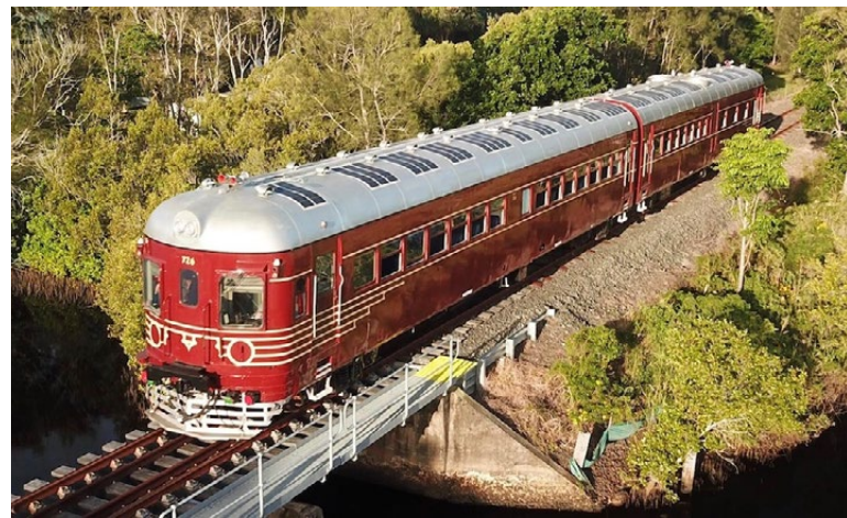
Abb 10 — Der Byron Solar Train fährt seit 2015 mit Solarenergie vom Dach. Die Anlage hat 6,5 kWp, weitere 30 kWp wurden auf dem Bahngelände verbaut, um die Batterie zusätzlich über Kabel aufzuladen © byronbaytrain •
