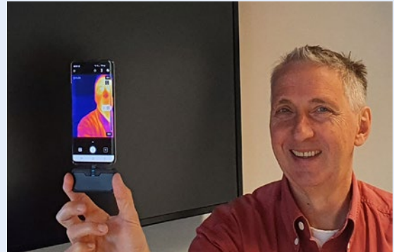
Abb 2 — Ausleihbarer Kameraaufsatz für Smartphones - so können Sie selbst ein Wärmebild erstellen •
